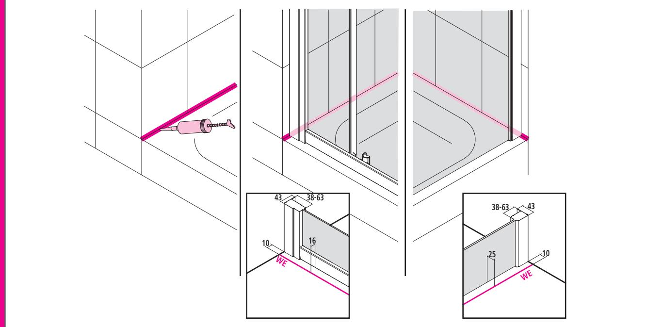
Einbaumaße / cotes d'implantation / fitting dimensions / inbouwmaat / Dimensioni di montaggio
